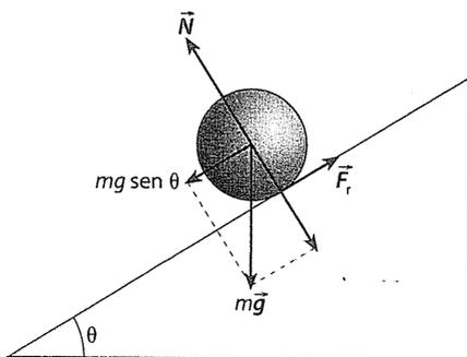
Podemos plantear una ecuación para el movimiento de traslación y otra para el movimiento de rotación, suponiendo que el cuerpo no se desliza:
